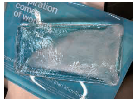
貝殻の粉をガラス硝材に混ぜて作られた試作。 右側に泡の出方が偏っている。
